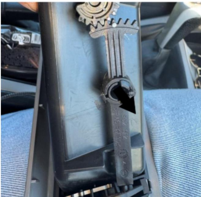
Nun die Lüftungseinheit entriegeln: Dafür sind 12 Nasen (6 pro Seite) vorgesehen. Mit einem Schlitzschraubendreher zunächst in die Kante reindrücken und dann nach hinten hebeln.
